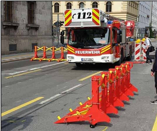
Abbildung 7: Durchfahrt eines Einsatzfahrzeugs durch eine mobile, dynamische Sperreinrichtung
