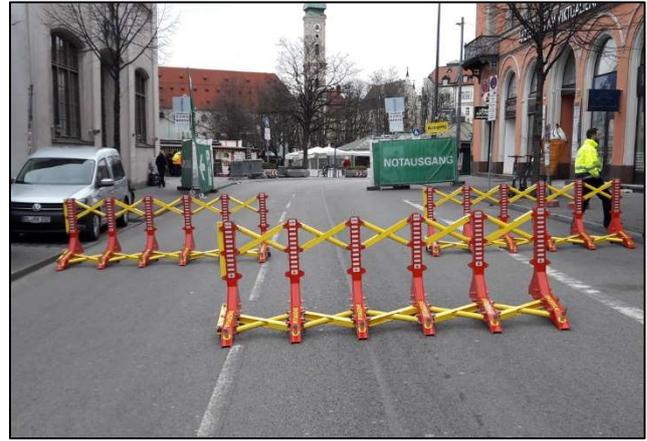
Abbildung 4: Pitagone als mobile, dynamische Sperreinrichtung
