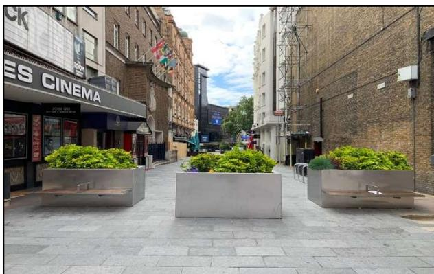
Abbildung 1: Stadtmöblierung als festinstallierte, statische Sperreinrichtung
