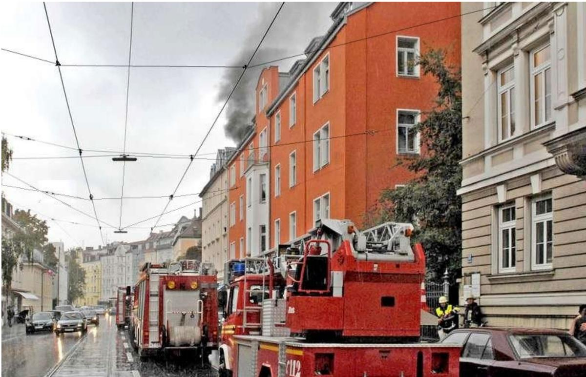
Die Anleitungung wird durch den Fahrdrabt erheblich behindert und ist durch die seitlichen Abspannungen unter Umstanden nicht moglich.
